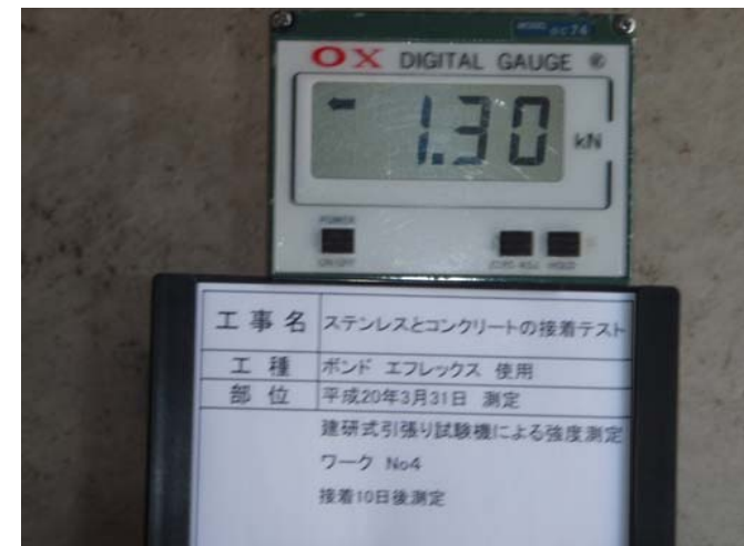
建研式引張り試験機での強度測定状況 測定値もハッキリわかります 『黒板らく太郎』は工事以外でもOK
